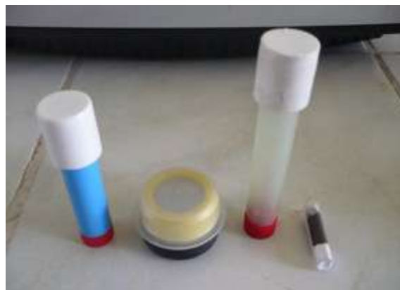
Figura 3: Dispositivos empleados en el muestreo pasivo de contaminantes gaseosos
