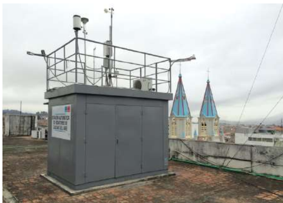
Figura 2: Estación automática de calidad del aire y meteorología localizada en la estación MUN
