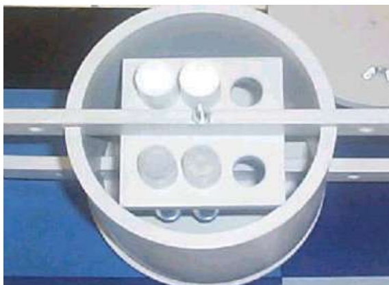
Contenedor de tubos pasivos
