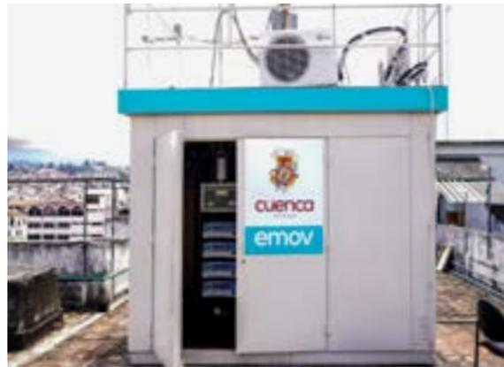
**Figura 2:** Estación automática de calidad del aire y meteorología localizada en la estación MUN
